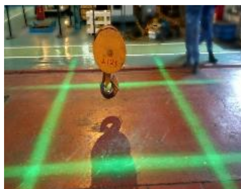
図2. クレーン下の注意喚起照明
